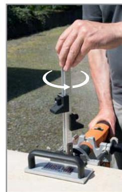
**Anschlagsschiene 360° drehbar:**
