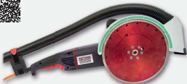
Der DOMINATOR 250 ist ein professioneller Trennschneider mit Absaughaube und Staubsaugeranschluss. Die großzügige Schutzhaube für Sägeblätter bis 250 mm Ø ermöglicht eine Schnitttiefe von 75 mm. Schutzhaube auch für wandnahes Schneiden mit Sägeblätter und Flansch geeignet.
