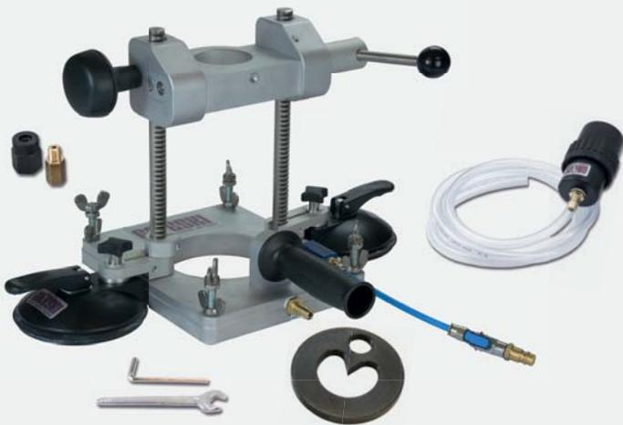
Bohrständer für Flächenbohrungen mit Saughaltern für glatte Oberflächen, geeignet für Bohrmaschinen bis Ø 53 mm Maschinenaufnahme (max. Bohrtiefe 150 mm oder alternativ 230 mm).
