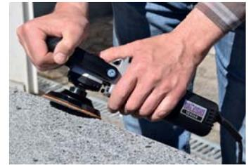
• Die Schleif- und Poliermaschine GENIUS 900 VARIO/B ist auch hervorragend geeignet zum Bohren, Schleifen und Polieren von Flächen, oder zum Herstellen von abgeschrägten Flächen an Werkstückkanten (Fasen) z.B. an Natursteinfliesen, Feinsteinzeug, dünnen Natursteinen, etc.
