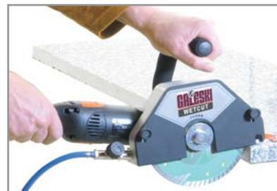
WETCUT 180/2: Abnehmbare Fußplatte für freies Schneiden bis 57 mm Schnitttiefe.
