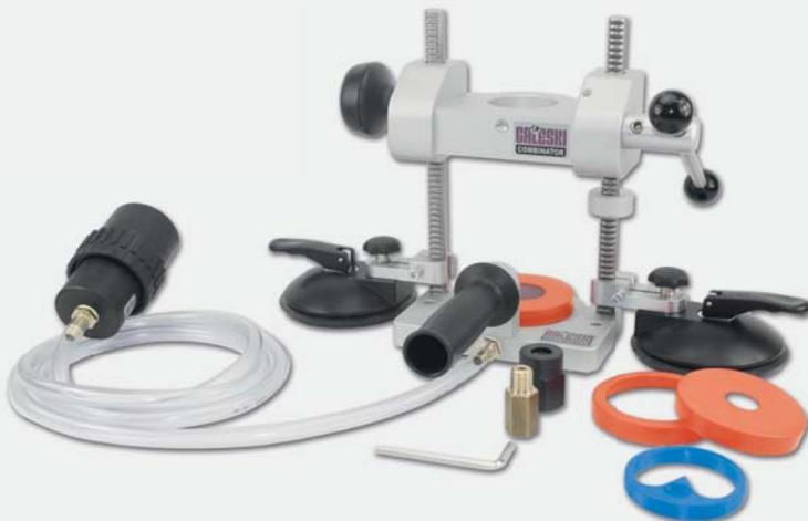
Bohrstand für Flächenbohrungen mit Saughaltern für glatte Oberflächen, geeignet für Bohrmaschinen bis Ø 53 mm Maschinenaufnahme (max. Bohrtiefe 150 mm oder alternativ 230 mm).
